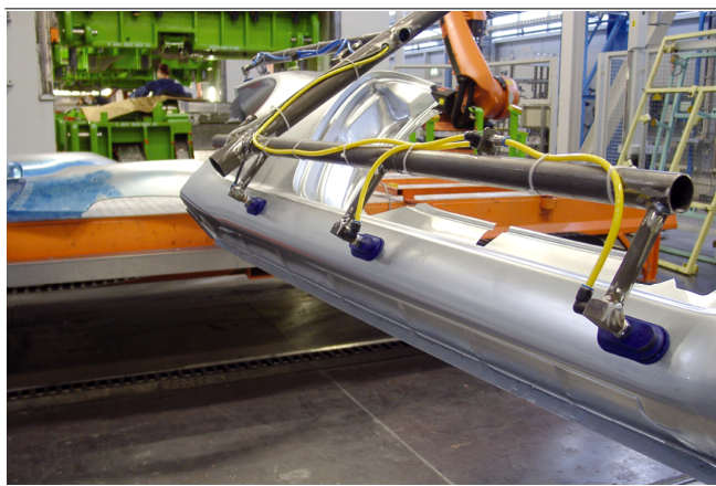
Сильфонные присоски SAOB, используемые для перемещения компонентов кузова автомобиля
